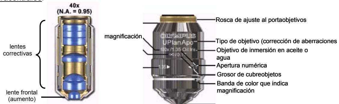
Figura 2: Complejidad de una lente objetiva y nomenclatura estándar. (Modificado de www.olympusmicro.com )
